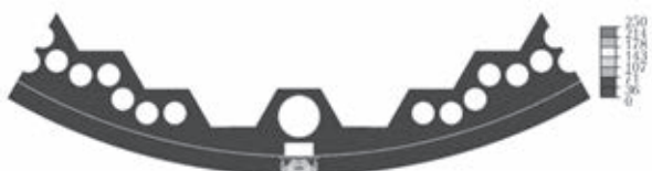
Рис. 8. Интенсивность напряжений (МПа) в продольном сварном шве в шахте в исходном состоянии
