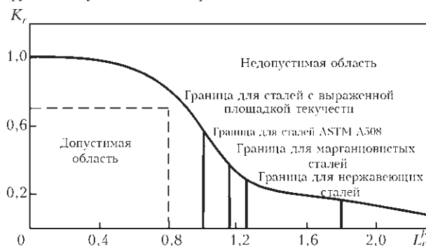
Рис. 5. Диаграммы предельного состояния K_r \leq f_1(L_r) для конструкционных сталей разного типа [12]
