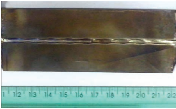
Рис. 11. Бездефектная пластина толщиной 3 мм сваренная при равномерном предварительном подогреве конструкции и с контролируемым остыванием после сварки
