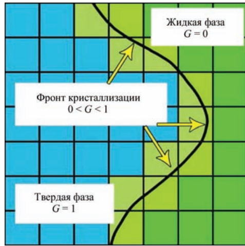
Рис. 1. Значение доли твердой фазы G для жидкости, твердой фазы и фронта кристаллизации
