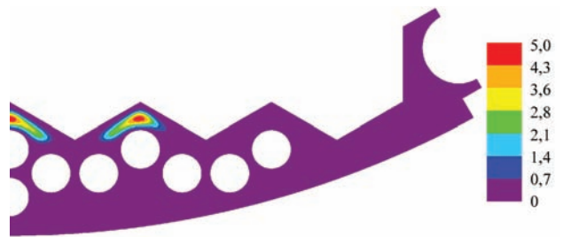
Рис. 8. Результат расчета распухания выгородки при параметрическом описании входных данных, % (табл. 2, n_R = 4, n_\theta = 1 )
