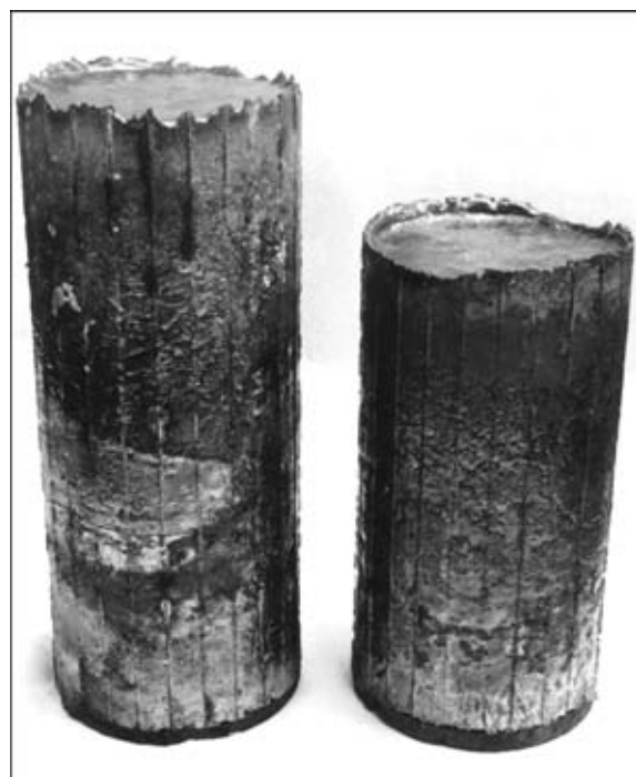
Рис. 4. Внешний вид слитков ИПСК из титанового сплава ОТ4-2. Диаметр слитков 225 мм
