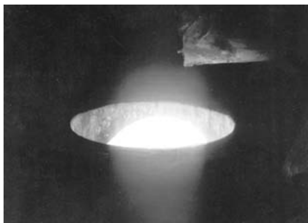
Рис. 1. Форма открытой поверхности металлической ванны при ИПСК. Диаметр кристаллизатора 69 мм
