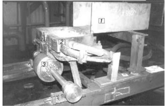
Рис. 4. Технологическая оснастка, смонтированная на подвижной раме: 1 — нерасходуемый короб; 2 — промежуточная емкость; 3 — барабан-кристаллизатор
