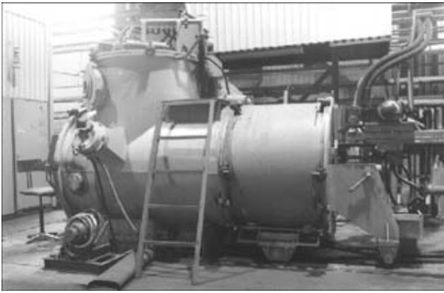
Рис. 3. Модернизированная электронно-лучевая установка УЭ-208
