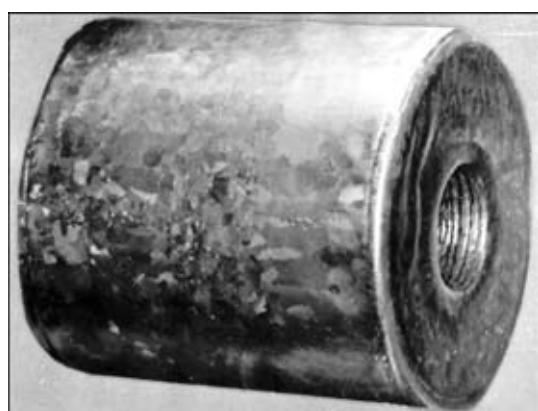
Рис. 5. Внешний вид полого слитка после оплавления
