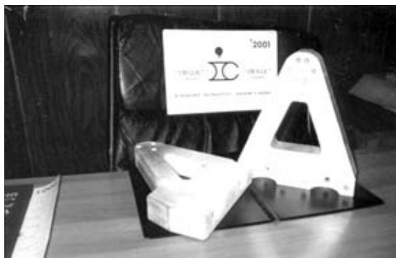
Рис. 5. Токоподводник к выкатной тележке
