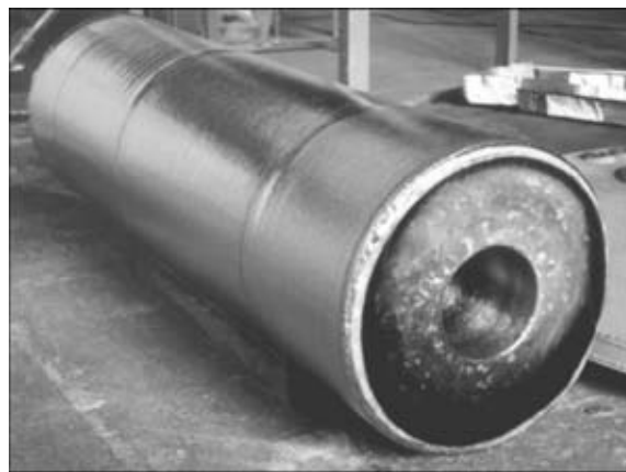
Рис. 5. Внешний вид оплавленного полого слитка титана внешним диаметром 600 и внутренним 200 мм
