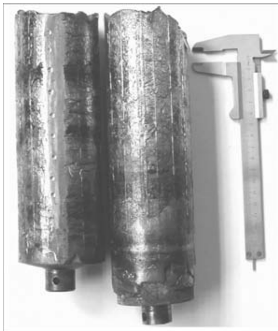
Рис. 7. Слитки ИПСК, выплавленные из газонасыщенного губчатого титана
