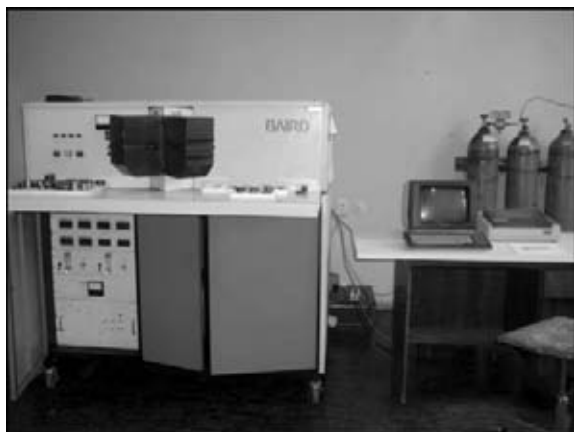
Рис. 1. Оптический эмиссионный спектрометр «Спектровак-1000»
