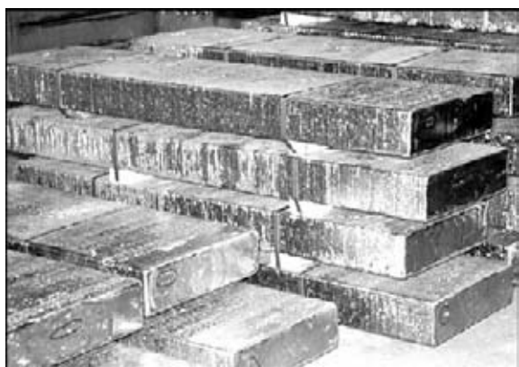
Рис. 1. Слитки-слябы (150×500×2000 мм) титанового сплава ВТ6 (Ti-6Al-4V), полученные способом ЭЛПЕ
