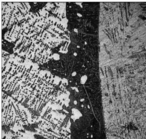
Рис. 10. Микроструктура ( \times 320 ) зоны соединения разнородных металлов (сталь + медь) в биметаллических слитках ЭШП ДС \varnothing 350 мм для подовых электродов дуговой печи
