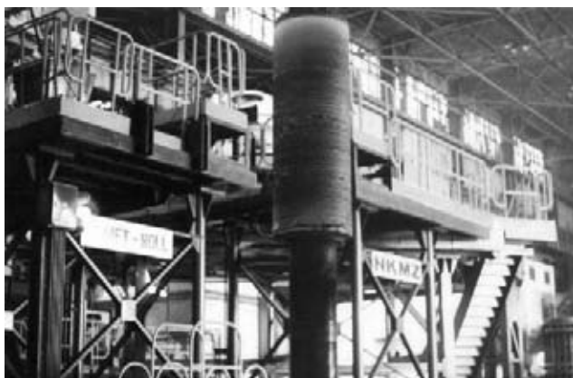
Рис. 7. Внешний вид промышленного агрегата ЭШН ЖМ на ЗАО «НКМЗ» и заготовки композитного прокатного валка \varnothing 740 мм, наплавленного способом ЭШН ЖМ
