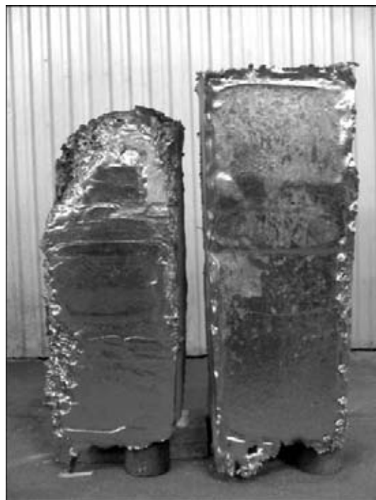
Рис. 2. Внешний вид блоков губчатого титана с оплавленной поверхностью
