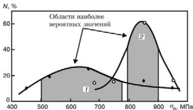
Рис. 3. Статистическая кривая распределения прочности паяных соединений сплава ВЖЛ12У, полученных с использованием борсодержащих припоев: 1 — без кремния (◆); 2 — с добавлением кремния (○); N — количество образцов
