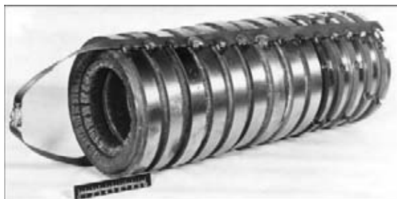
Рис. 5. Расходуемая заготовка, собранная из отработанных фланцев титанового сплава ОТ4-2
