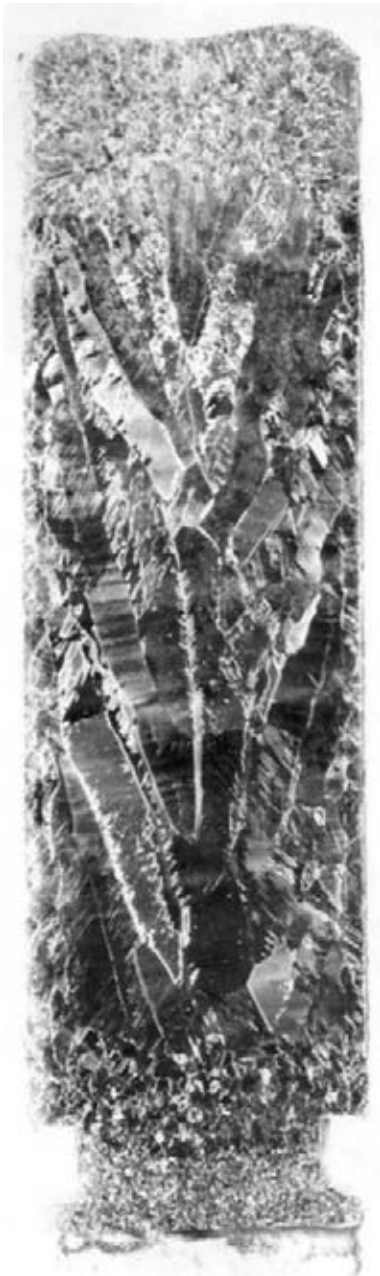
Рис. 3. Макроструктура слитка ИПСК сплава BT5-1 кт
