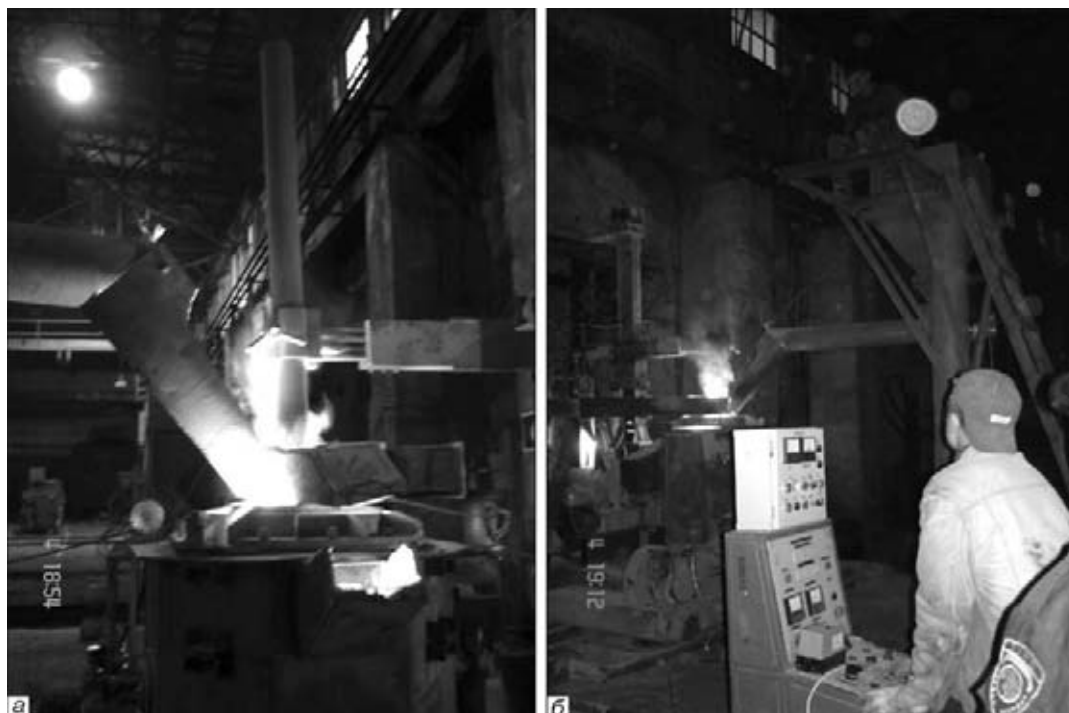
Рис. 4. Плавка ванадиевого шлака в электрошлаковой печи: а — печь; б — процесс плавки
