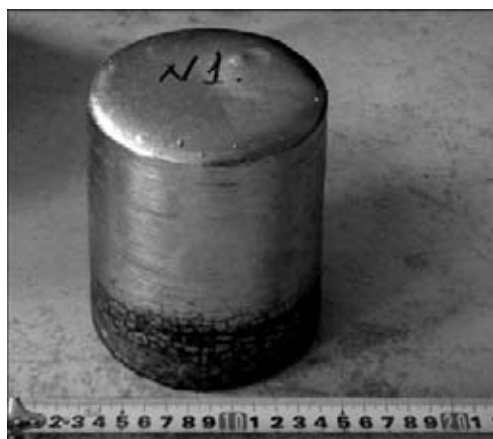
Рис. 3. Слиток ЭШП из титановой губки ТГ-110 (плавка 1)
