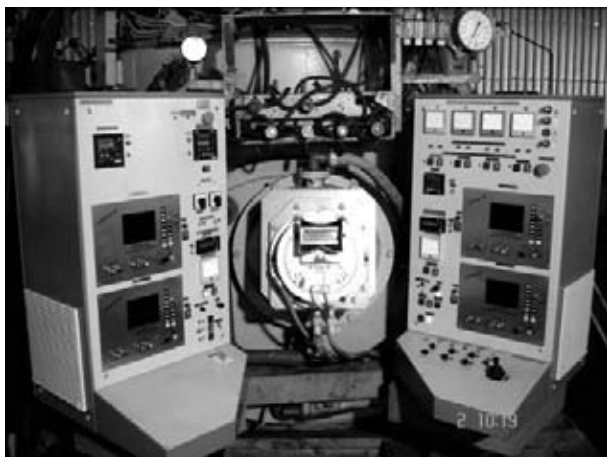
Рис. 2. Главный пульт управления установкой TICO-15M
