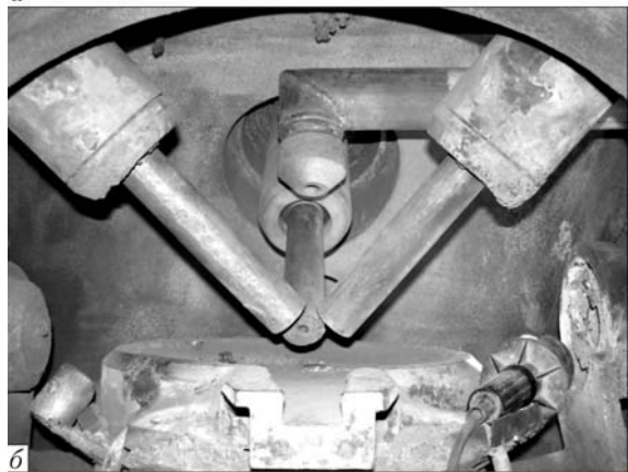
Рис. 1. Схема (а) и внешний вид (б) экспериментального трехфазного плазменного реактора: 1 — плазменные нагреватели; 2 — фурма; 3 — шлакоуловитель; 4 — камера
