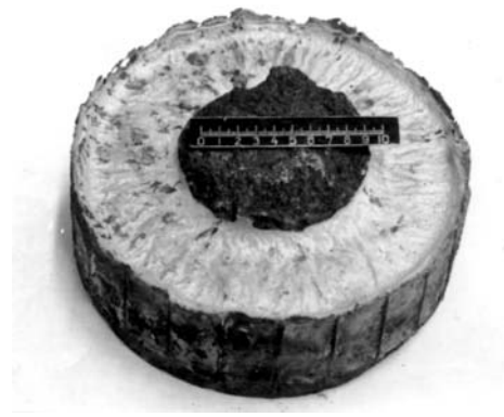
Рис. 12. Отливка-заготовка диаметром 220 мм с графитовым стержнем, полученная на установке ИПСК
