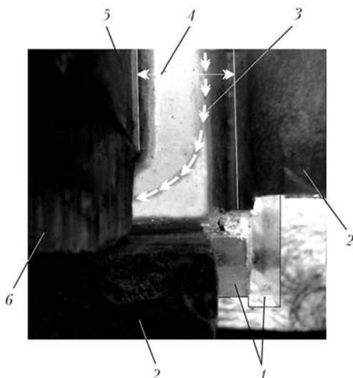
Рис. 2. Вращение горизонтального потока при наплавке в токоподводящем кристаллизаторе (вид сверху): 1 — стенки корпуса кристаллизатора; 2 — электроды токоподводящей секции; 3 — поток моделирующего шлак раствора; 4 — зазор (17,5 мм); 5 — наплавляемая заготовка; 6 — деревянная распорка
