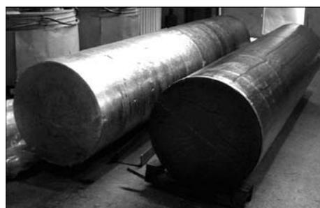
Рис. 3. Оплавленный слиток диаметром 850 мм
