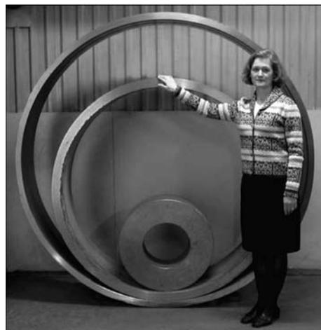
Рис. 11. Раскатные кольца диаметрами 1850 и 1415 мм
