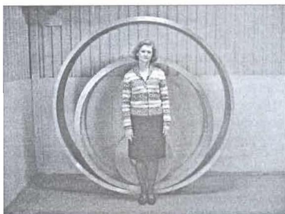
Рис. 5. Раскатные кольца диаметрами 1850 и 1415 мм
