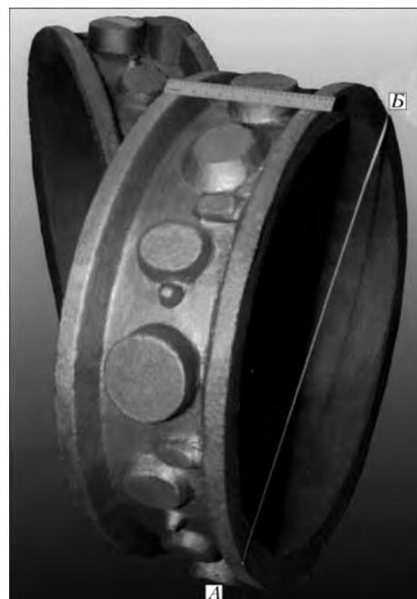
Рис. 1. Отливки ЦЭШЛ из стали ЭП 517
