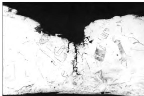
Рис. 5. Темплет разрушенного электрода
