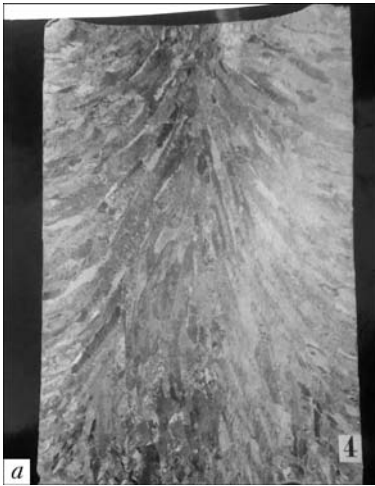
Рис. 5. Темплеты слитка ДШП из титана марки ВТ1-0 с применением флюсов CaF 2 (а) и CaF 2 + ФРЗМ (30 %) (б)
