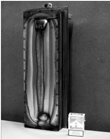
Рис. 5. Общий вид модернизированного магнетрона с прямым охлаждением мишени-катода
