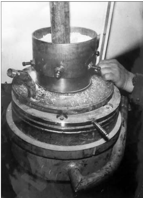
Рис. 3. Флюсовый затвор с устройством для продувки аргоном
