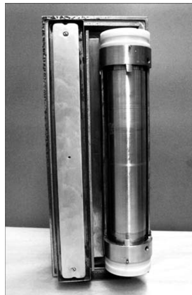
Рис. 8. Общий вид блока катодного узла тлеющего разряда и дуготрона с кобальтовым катодом
