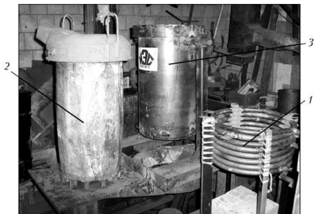
Рис. 2. Общий вид плавильно-разливочного модуля: 1 — индуктор; 2 — ковш; 3 — разливочный модуль
