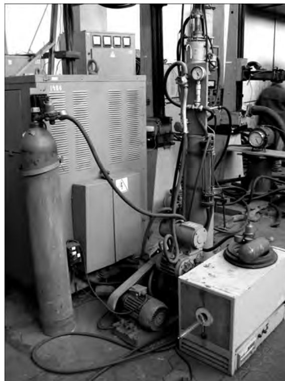
Рис. 2. Общий вид камерной печи ЭШП с дозирующими устройствами и источником питания
