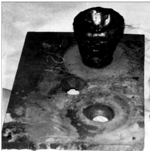
Рис. 5. Лист стали толщиной 20 мм с отверстиями, проплавленными струей расплавленной стали, с заготовкой для плавления заготовок массой 5,0...5,5 кг (температура 1420...1520 °С) при практически одинаковой мощности индуктора в пределах (170...180 кВт).
