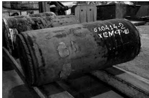
Рис. 6. Слитки ЭШП диаметром 800 мм стали X12MФ-Ш, выплавленные при ЭШП электрода сечением 370×370 мм с подъемом вводимой мощности
