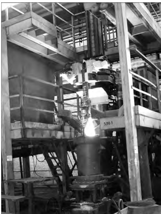
Рис. 2. Фрагмент плавки слитка из сплава ХН73МБТЮ на установке УШ116
