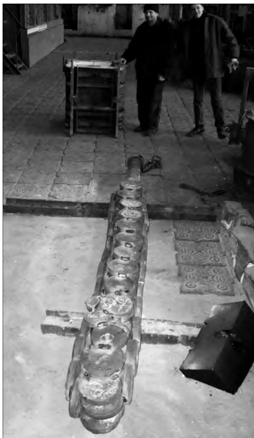
Рис. 1. Составной расходный электрод из отходов сплава ХН73МБТЮ
