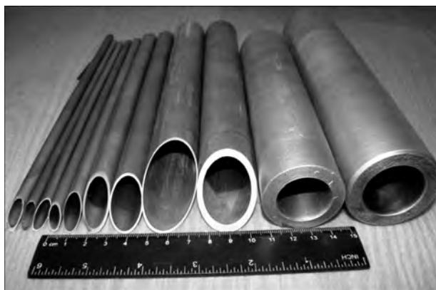
Рис. 2. Трубы различного диаметра из молибдена ЭЛПЕ
