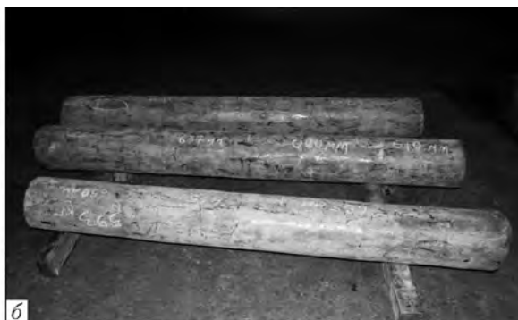
Рис. 6. Полуфабрикаты из жаропрочного титанового сплава ВТЗ-1: а — поковки; б — прутки
