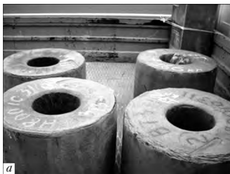
Рис. 6. Полуфабрикаты из жаропрочного титанового сплава ВТЗ-1: а — поковки; б — прутки
