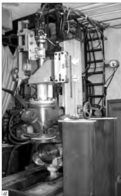
Рис. 1. Внешний вид (а) и схема (б) плазменно-дуговой установки ОП-133
