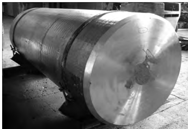
Рис. 4. Слиток жаропрочного титанового сплава ВТЗ-1 диаметром 840 мм, длиной 4000 мм
