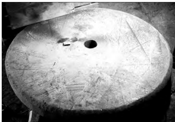
Рис. 5. Кованый диск диаметром 1600 мм из жаропрочного титанового сплава ВТЗ-1
