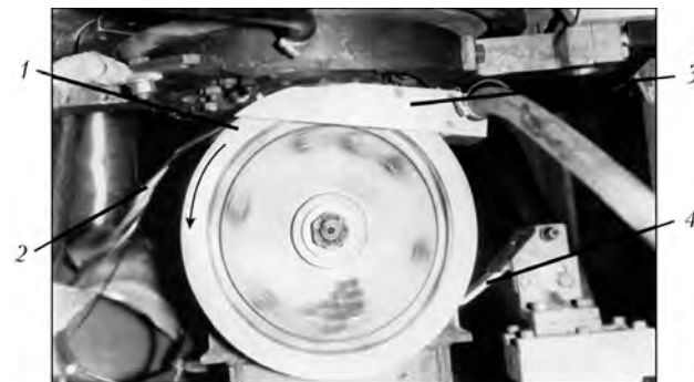
Рис. 4. Фотография слива расплава на барабан-холодильник: 1 — барабан-холодильник; 2 — лента; 3 — защитный чехол; 4 — фторопластовый «нож»
