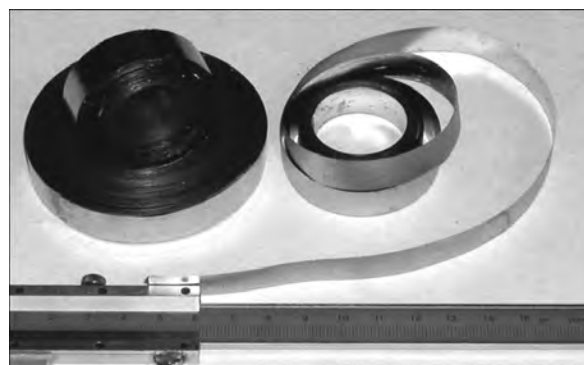
Рис. 11. Быстрозакаленная лента с аморфной структурой шириной 15 мм, толщиной 50 мкм Ni-Si-B
