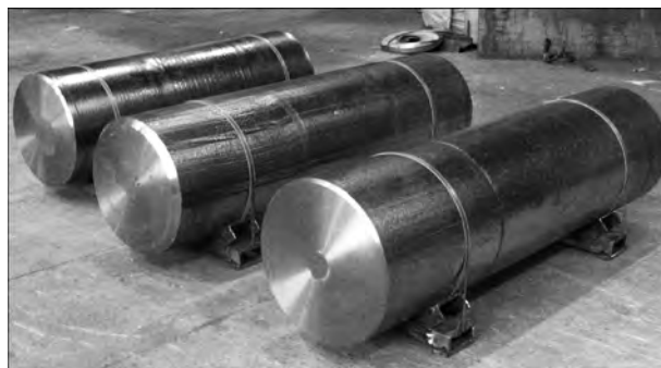
Рис. 1. Слитки титанового сплава VT20 диаметром 500 мм
