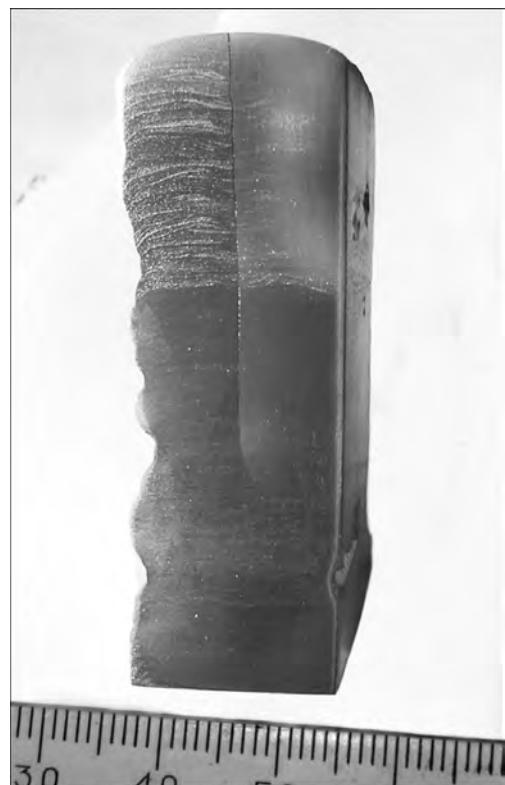
Рис. 4. Макроструктура поперечного сечения монокристалла вольфрама (110)
