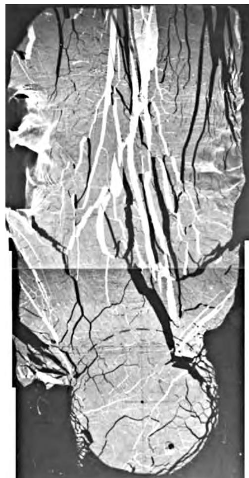
Рис. 7. Рентгеновская топограмма продольного сечения плоского монокристалла вольфрама (110)
