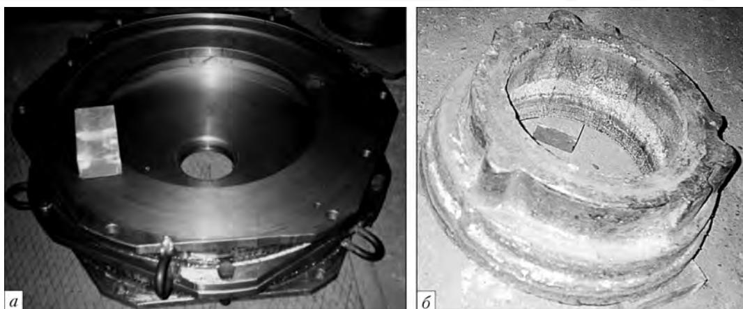
Рис. 2. Цельный «вытряхной» одноместный кокиль ЦЭШЛ (а) и заготовка зубчатого колеса для карьерного автомобиля МАЗ (б)
