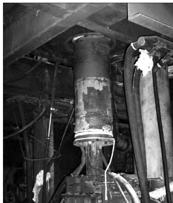
Рис. 7. Вытяжки из кристаллизатора сталемедного слитка
