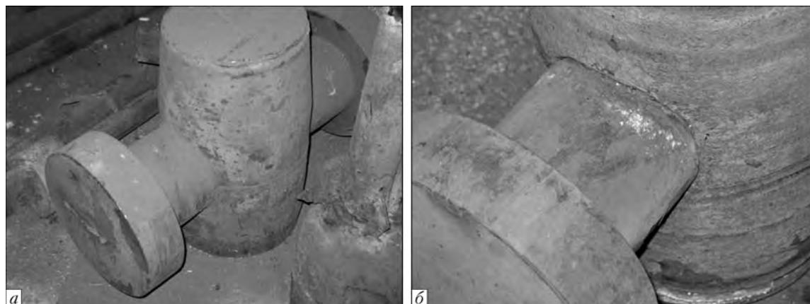
Рис. 2. Внешний вид соединений центральной части корпуса задвижки с неизолируемым (а) и изолированным (б) патрубками
