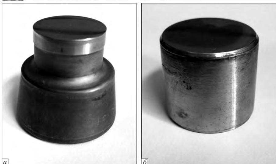
Рис. 1. Заготовки чеканочного инструмента из стали 5ХВ2С: *a* — стандартная; *b* — полученная способом электронно-лучевого переплава с промежуточной емкостью (ЭЛПЕ)
