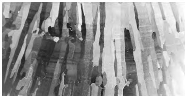
Рис. 4. Макроструктура слитка молибдена ЭЛПЕ диаметром 70 мм, модифицированного карбидом циркония
