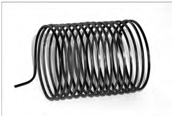
Рис. 5. Проволока сплава Ti-55Ni (мас. %) сечением 1,2×1,2 мм, полученная с помощью холодной прокатки
