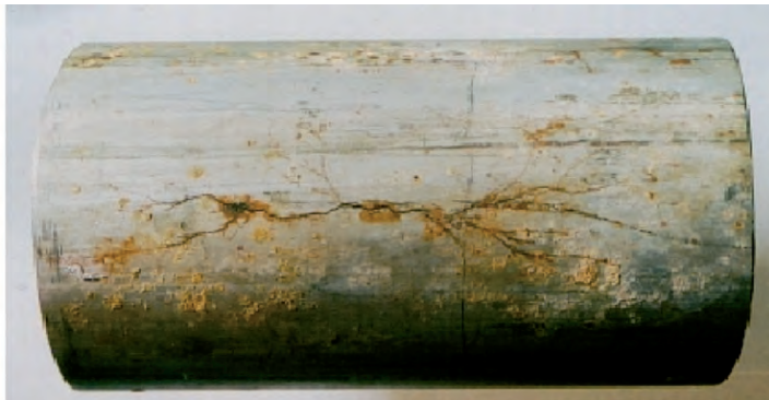
Коррозионное растрескивание под напряжением трубопровода из нержавеющей стали 316L.
