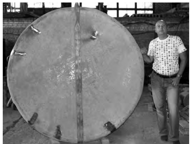
Рис. 9. Поковка диаметром 1950×160 мм из жаропрочного титанового сплава BT3-1
