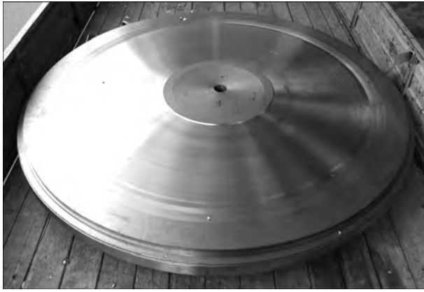
Рис. 10. Диск диаметром 1900×150 мм из жаропрочного титанового сплава ВТЗ-1
