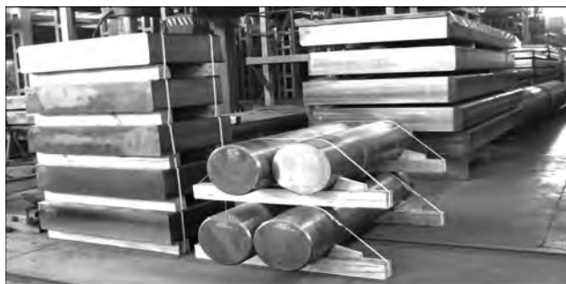
Рис. 3. Титановые слитки круглого и прямоугольного сечения (слябы)
