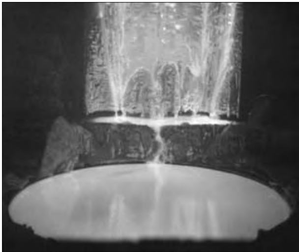
Рис. 1. Процесс плавки слитка титанового сплава ВТЗ-1 диаметром 840 мм
