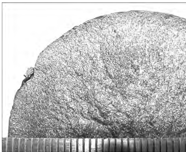
Рис. 2. Излом отливки \gamma -TiAl
