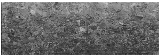
Рис. 9. Макроструктура поковки титанового сплава ВТ6
