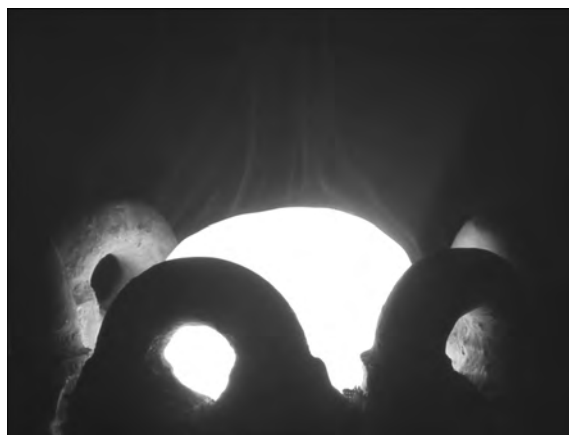
Рис. 4. Плавка кремния при ИПСК в разреженной атмосфере
