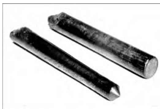
Рис. 2. Внешний вид слитков карбидов вольфрама WC-W 2 C, полученных способом выплавки в печи Таммана
