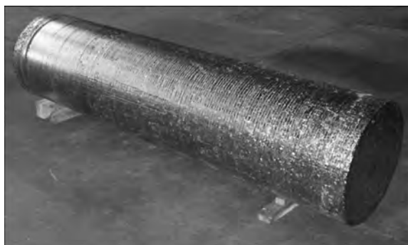
Рис. 1. Слиток титанового сплава ВТ6 диаметром 600 мм
