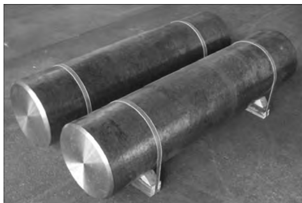
Рис. 6. Оплавленные слитки диаметром 600 мм титанового сплава BT6
