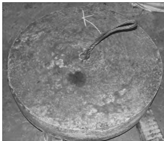
Рис. 7. Поковка диаметром 870x160 мм из титанового сплава BT6
