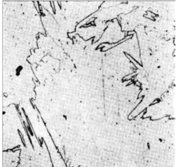
Рис. 3. \alpha' -фаза в техническом титане, \times 300
