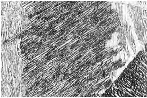
Рис. 3. Микроструктура (X100) слитка титана марки ВТ6
