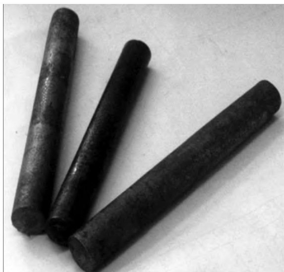
Рис. 4. Внешний вид слитков карбидов вольфрама, выплавленных в индукционной печи
