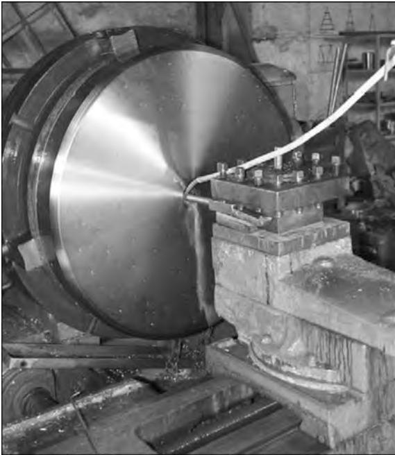
Рис. 8. Диск диаметром 870×150 мм из титанового сплава ВТ6
