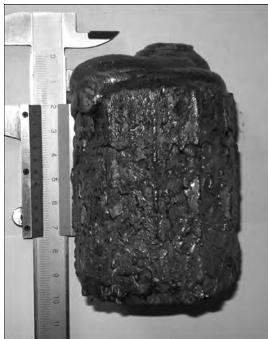
Рис. 3. Слиток кремния, выплавленный при ИПСК с вытягиванием
