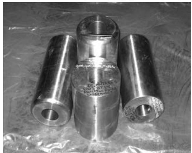
Рис. 4. Полые слитки, подготовленные для прессования
