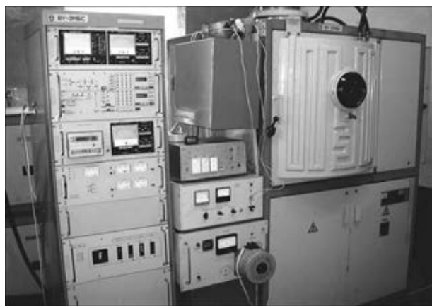
Рис. 1. Модернизированная установка для микродугового вакуумного нанесения покрытий ВУ-2МБС (М)
