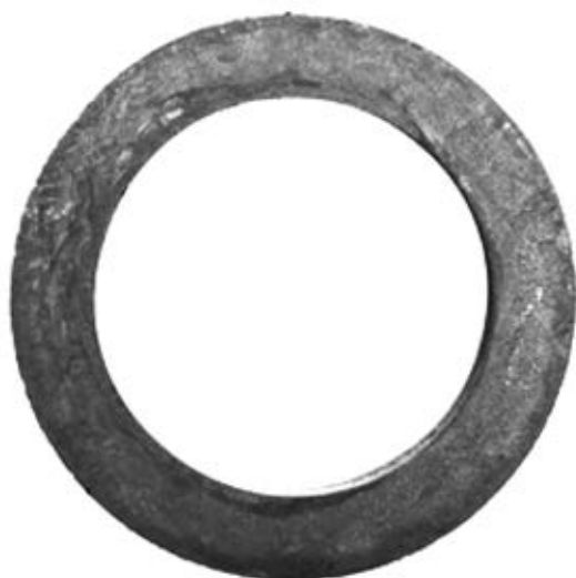
Рис. 6. Макроструктура горячепрессованной трубы диаметром 82x14 мм
