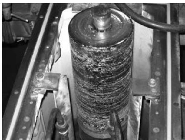
Рис. 2. Полый слиток с диаметрами наружным 190 и внутренним 50 мм в камере после плавки
