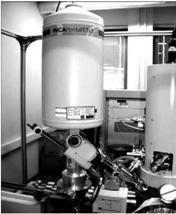
Рис. 3. Ракурс ЭДС OXFORD EDS INCA Energy 350
