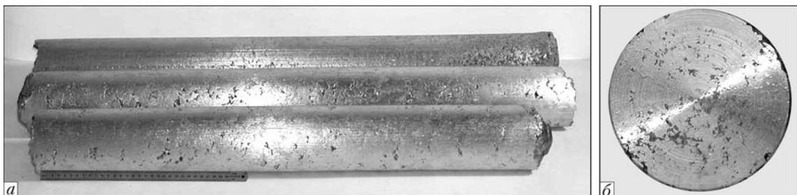
Рис. 2. Внешний вид прессованных электродов диаметром 75 мм (а) и макротемплет поперечного сечения электрода (б)
