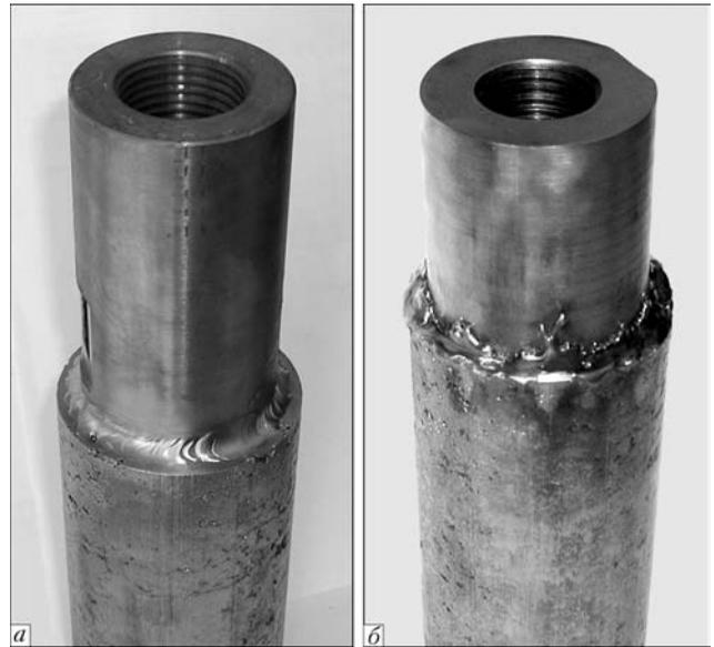
Рис.3. Внешний вид сварных соединений инвентарной головки и прессованного электрода, выполненных аргонодуговой (а) и контактной (б) сваркой
