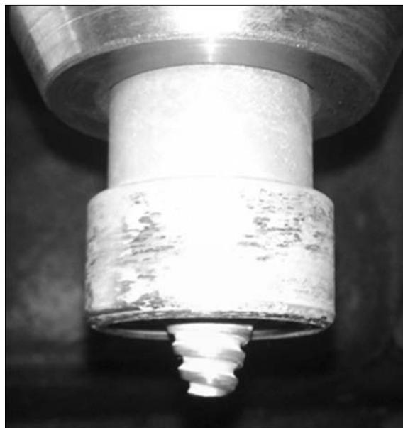
Рис. 3. Рабочий инструмент для НТП
