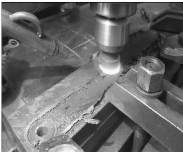
Рис. 6. Процесс наплавки образца плиты
