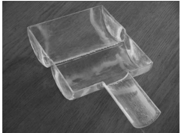
Рис. 3. Двухсекционная кварцевая промежуточная емкость со сливным лотком
