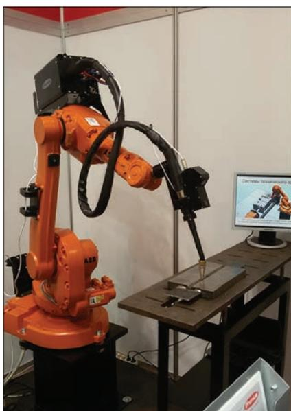
Система технического зрения для промышленных сварочных роботов, разработанная в ИЭС им. Е.О. Патона НАНУ
