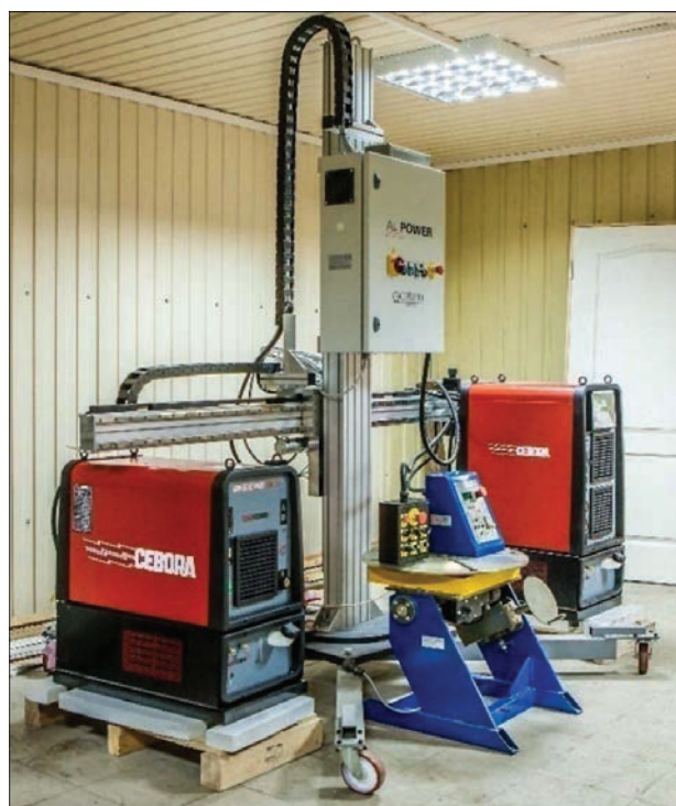
Инновационное универсальное оборудование для плазменной, гибридной и комбинированной (тандем) «Плазма-МИГ» сварки, разработанное в ИЭС им. Е. О. Патона и поставленное на лабораторно-технологическую базу КУИС в г. Гуанчжоу, КНР
