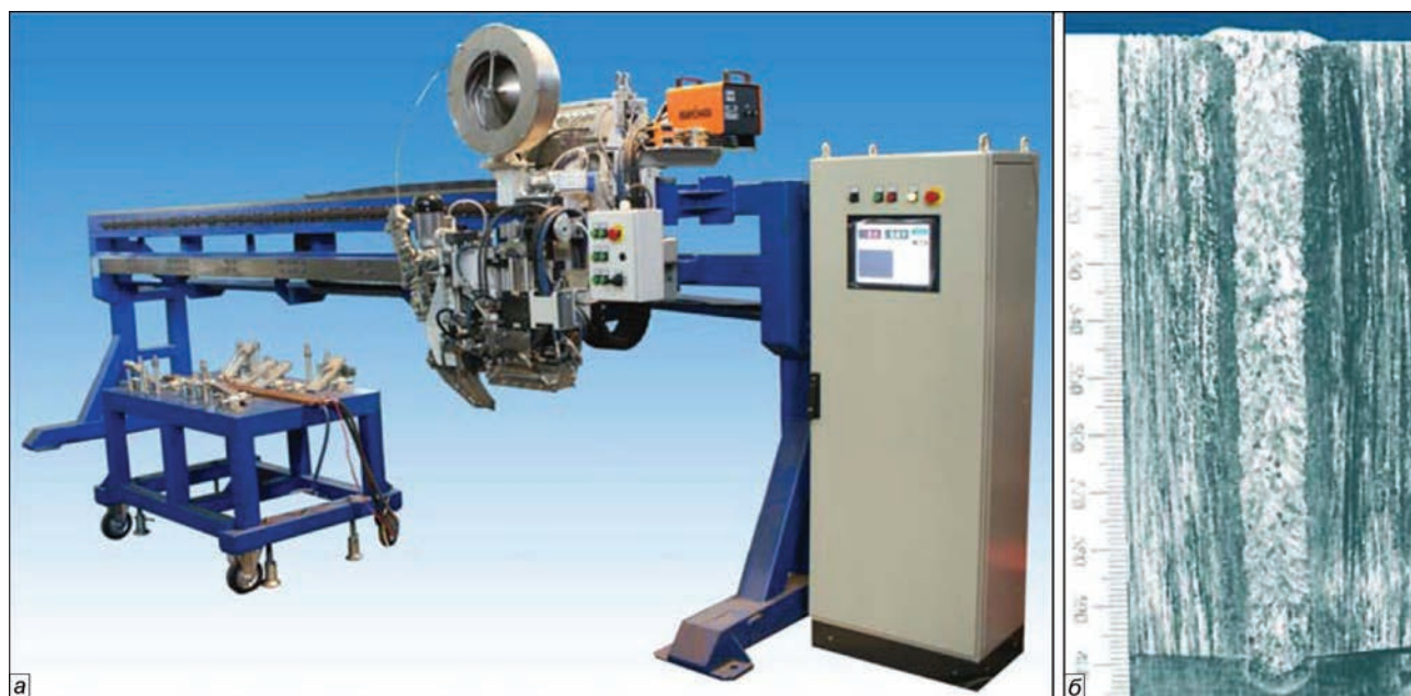
Прототип установки для получения сварных соединений из титана и титановых сплавов длиной до 4 м и толщиной до 120 мм (а) и макросечение сварного соединения из титана повышенной толщины (б)
