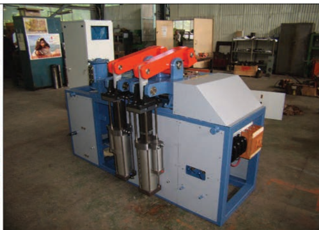
Оборудование для контактной стыковой сварки оплавлением, разработанное в ИЭС им. Е. О. Патона и поставленное на лабораторно-технологическую базу КУИС в г. Гуанчжоу, КНР
