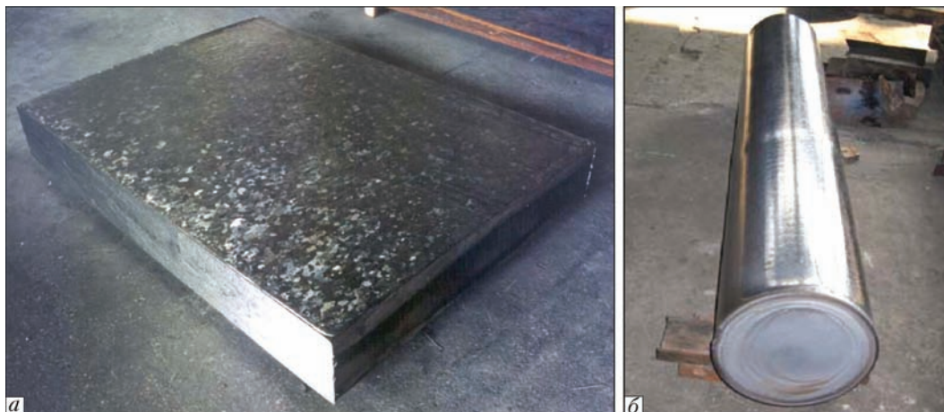
Рис. 5. Внешний вид боковой поверхности слитков, оплавленных электронным лучом: а — 530×165; б — диаметр 400 мм
