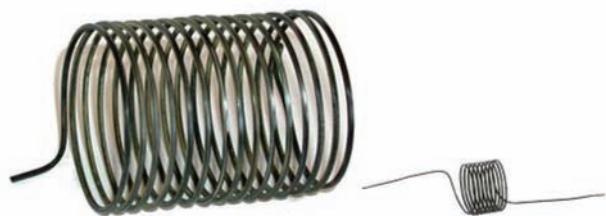
Проволока сплаву Ti-50Ni діаметром 1,2 і 0,4 мм, отримана зі зливків МЕП
