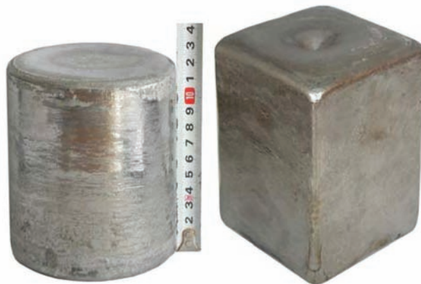
Зливки сплаву Ti-50Ni, отримані методом МЕП
