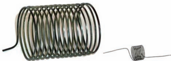
Проволока сплаву Ti-50Ni діаметром 1,2 і 0,4 мм, отримана зі зливків МЕП
