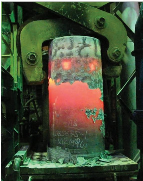
Рис. 18. Слиток из стали X12MФ-Ш диаметром 800 мм и массой 6 т
