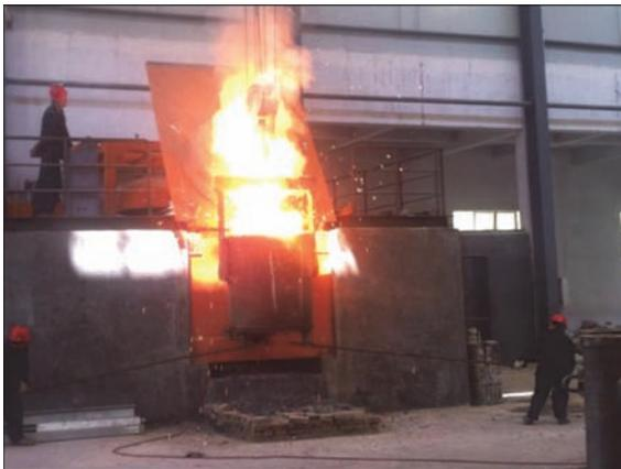
Рис. 4. Вакуумно-индукционная печь для дегазации металла в вакууме
