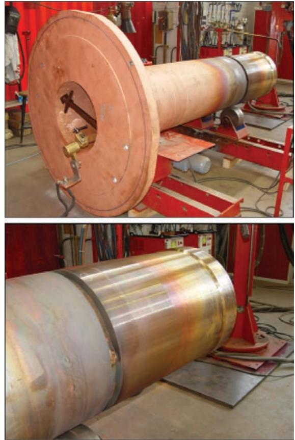
Рис. 15. Ремонт кокилей путем увеличения корпуса (удлинения)
