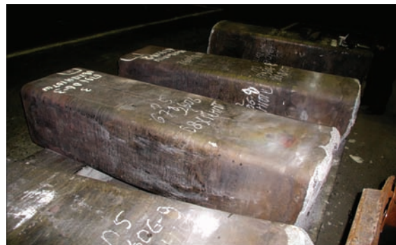
Рис. 20. Слитки из стали 08X18N10T-III сечением квадрат 565 мм и массой 4,3 т
