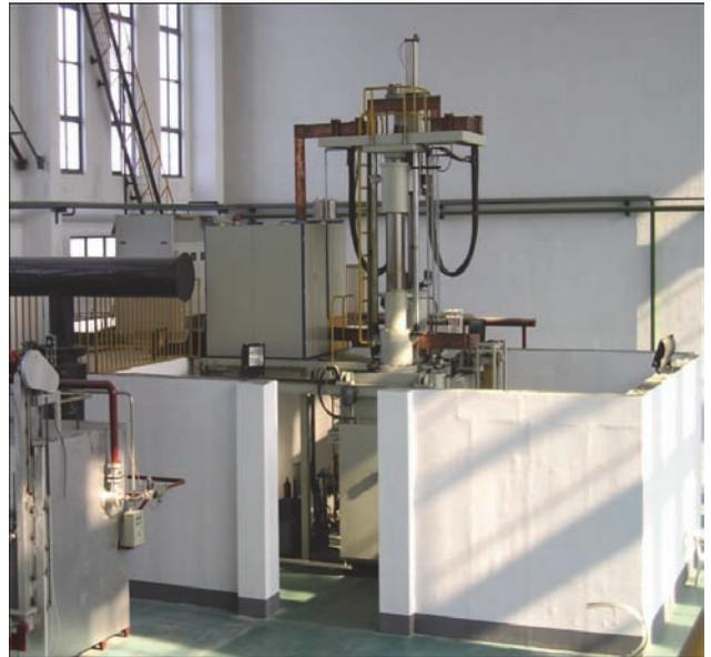
Рис. 6. Печь для ВДП и центробежного литья заготовок
