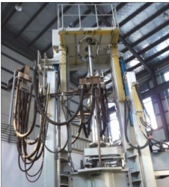
Рис. 5. Печь для вакуумно-дугового переплава
