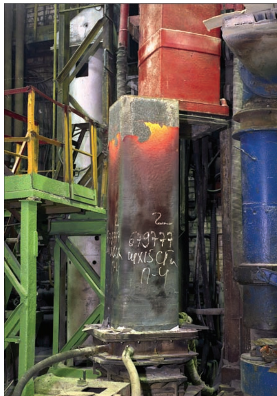
Рис. 19. Слиток из стали ШХ15СГ-III сечением квадрат 565 мм при извлечении из кристаллизатора
