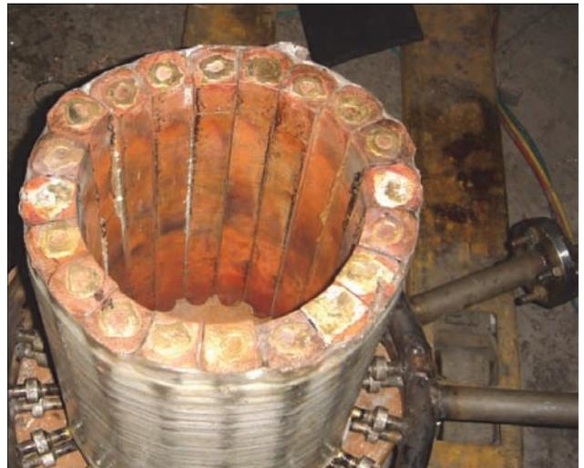
Рис. 7. Вакуумно-индукционная печь с холодным подом
