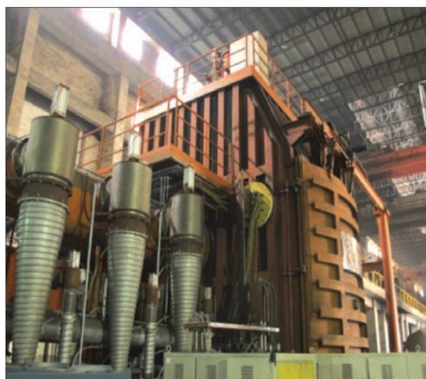
Рис. 2. Вакуумно-индукционные печи
