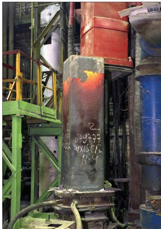
Рис. 19. Слиток из стали ШХ15СГ-Ш сечением квадрат 565 мм при извлечении из кристаллизатора
