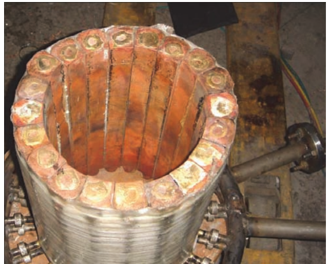
Рис. 7. Вакуумно-индукционная печь с холодным подом
