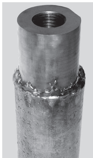
Рис. 4. Внешний вид сварного соединения инвентарной головки и прессованного из губчатого титана электрода, выполненного контактной сваркой
