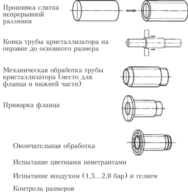
Рис. 6. Основные стадии производства круглых кристаллизаторов, изготавливаемых ковкой из слитков
