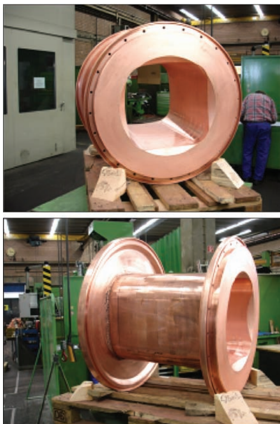
Рис. 10. Подвижные кристаллизаторы прямоугольного сечения сталлизаторы с большим фланцем требуют его приварку.
