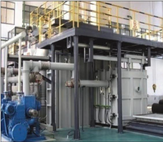
Рис. 3. Вакуумная печь для точного фасонного литья
