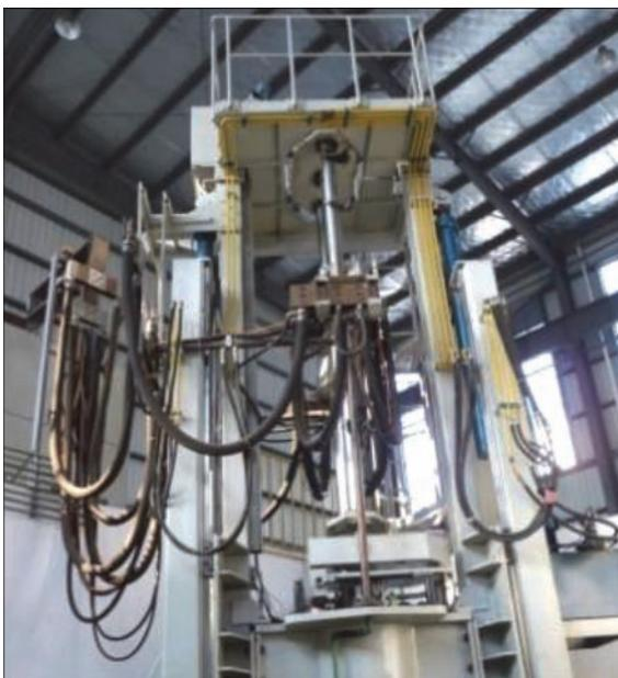
Рис. 5. Печь для вакуумно-дугового переплава
