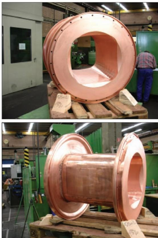
Рис. 10. Подвижные кристаллизаторы прямоугольного сечения
