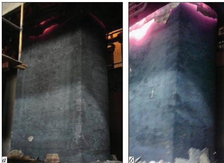
Рис. 4. Слябы ЭШП размерами, мм: 950×2000×2800 (а), 750×2000×2760 (б)
