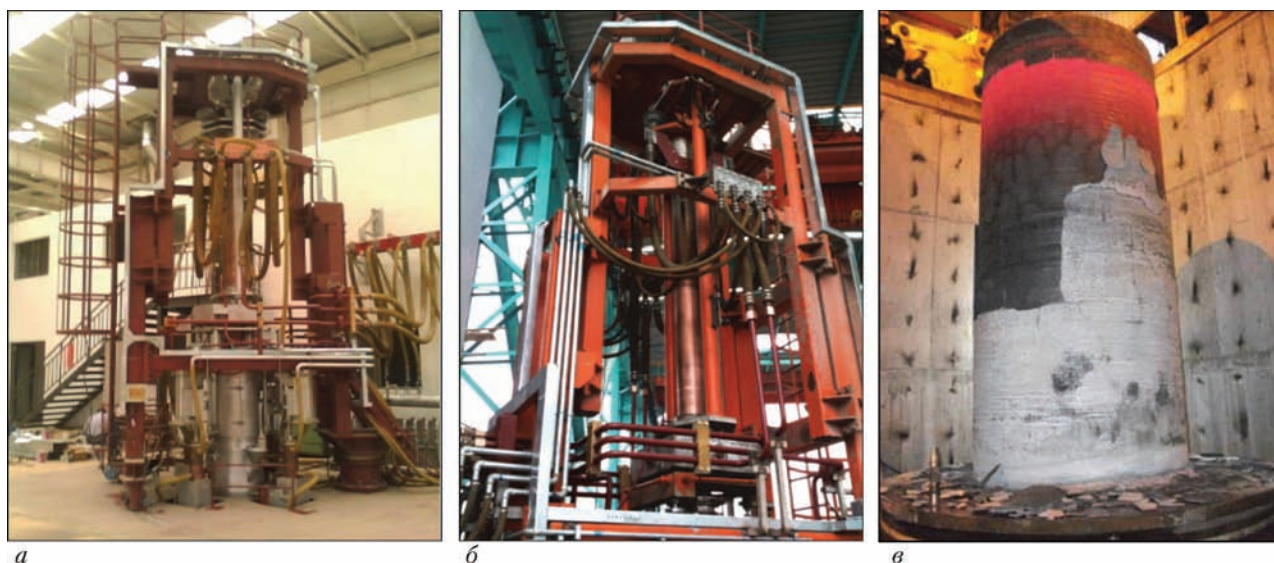
Рис. 1. Печи для ЭШП (а, б) и крупнотоннажный слиток (в)
