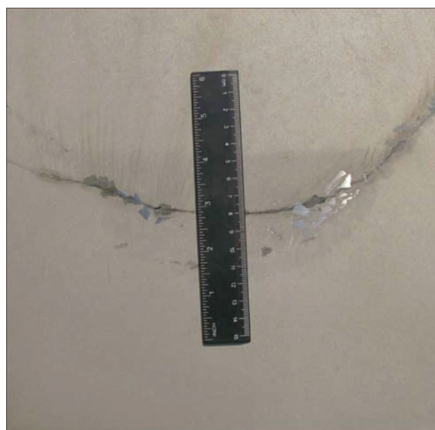
Рис. 5. Макроструктура и глубина металлической ванны слитка диаметром 300 мм стали X12MФ-Ш, выплавленного с введением инокуляторов в процессе ЭШП (пятый вариант выплавки)
