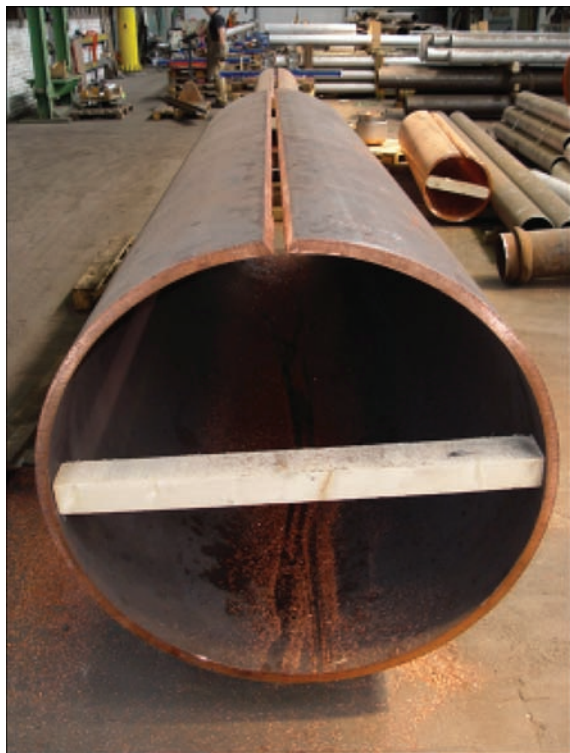
Рис. 1. Корпус кристаллизатора готовый для сварки
