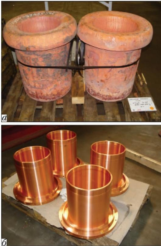
Рис. 13. Бесшовные кованные кристаллизаторы для ЭШП (а, б — см. в тексте)
