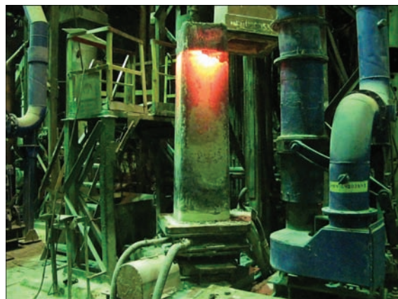
Рис. 22. Слиток из стали ЧС82-Ш сечением квадрат 565 мм при извлечении из кристаллизатора
