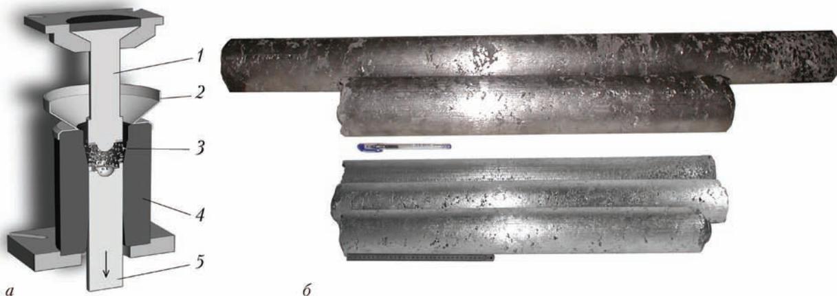
Рис. 2. Схема процесса прессования (а) и внешний вид полученных из губчатого титана электродов диаметром 75 и 100 мм (б): 1 — пуансон; 2 — приемная воронка; 3 — шихта; 4 — конусная, проходная пресс-форма; 5 — электрод
