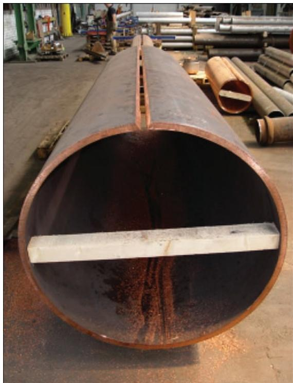
Рис. 1. Корпус кристаллизатора готовый для сварки
