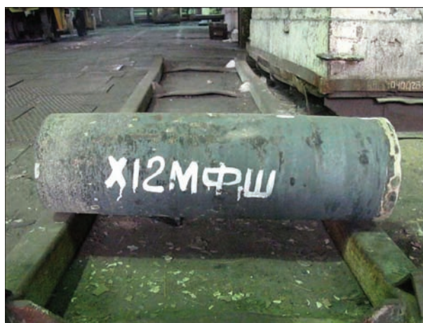
Рис. 4. Слиток ЭШП стали X12MФ-Ш диаметром 300 мм, выплавленный с введением инокуляторов в процессе ЭШП куляторов массовая скорость сплавления электрода снижается с 3,1 до 2,0 кг/мин, т. е. на 32 %. В то же время суммарная производительность процесса ЭШП за счет добавления инокуляторов увеличивается от 13 до 55 % (рис. 3). Расход электроэнергии с учетом массы добавленных гранул уменьшился на 8...16 % и находился в пределах 1345...1470 кВт·ч/т. При выплавке слитка диаметром 300 мм и массой 1,0 т средний расход электроэнергии по стандартной технологии составлял 1600 кВт·ч/т.
