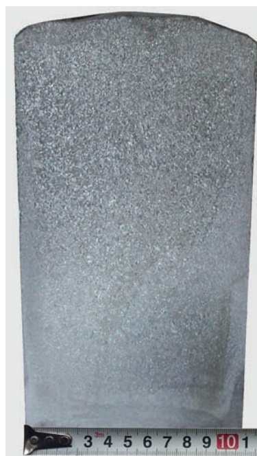
Рис. 6. Макроструктура продольного сечения титанового слитка, выплавленного способом ЭШП с электромагнитным воздействием на металлургическую ванну
