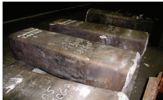
Рис. 20. Слитки из стали 08X18N10Т-Ш сечением квадрат 565 мм и массой 4,3 т
