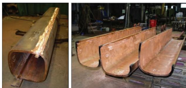
Рис. 2. Кристаллизаторы, изготавливаемые по обычной технологии прямоугольного сечения
