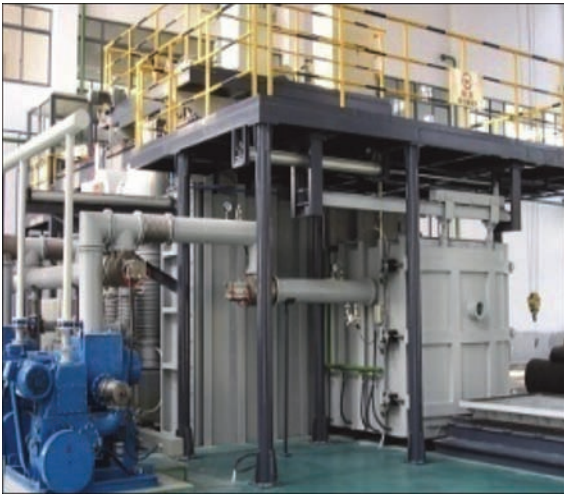
Рис. 3. Вакуумная печь для точного фасонного литья
