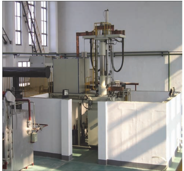
Рис. 6. Печь для ВДП и центробежного литья заготовок
