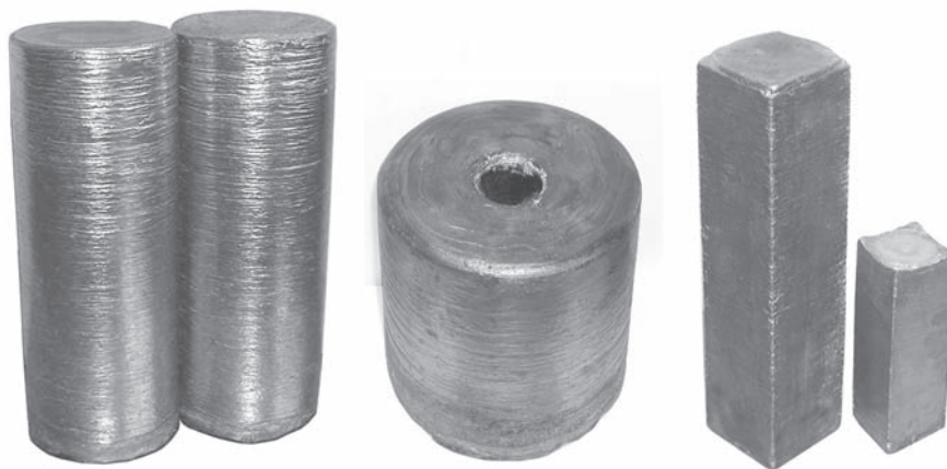
Рис. 5. Слитки титановых сплавов, полученные способом ЭШП
