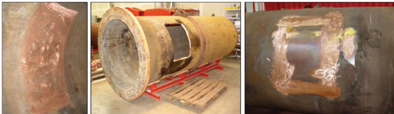
Рис. 17. Ремонт кокилей путем замены дефектных участков
