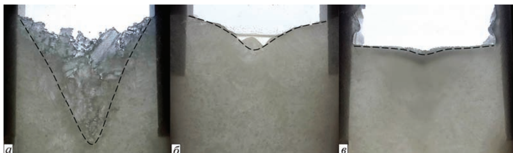
Рис. 7. Структура головной части модельных кузнечных слитков: a — без ЭШО; б — с ЭШО; в — с ЭШО и подпиткой
