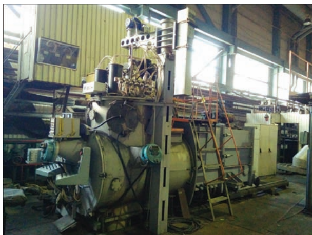
Рис. 1. Внешний вид лабораторной электронно-лучевой установки УЭ-208М
