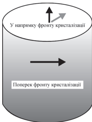
Рис. 2. Схема розрізання вилівку композиційного матеріалу Ti–TiB 2 , отриманого електронно-променевою плавкою на установці UE-208
