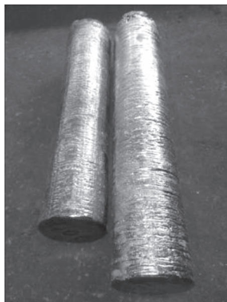
Рис. 8. Внешний вид слитков диаметром 150 мм сплава Т120
