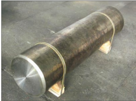
Рис. 4. Внешний вид слитка диаметром 400 мм из титанового сплава Т110
