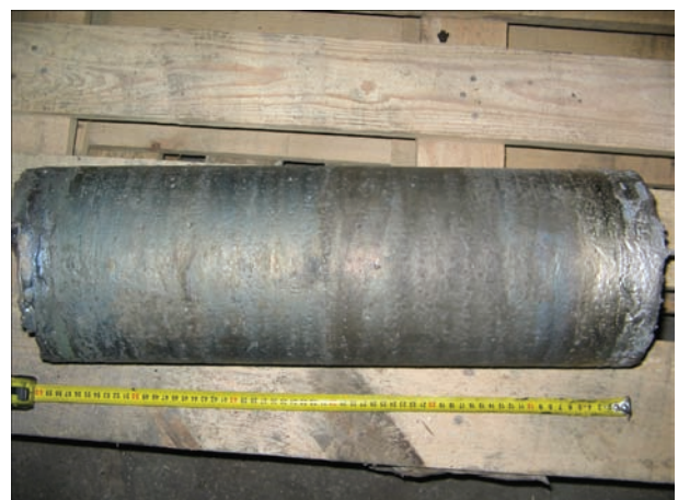
Рис. 7. Внешний вид слитка сплава системы Ni–Al–Cr
