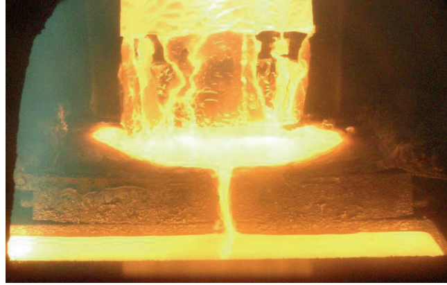
Виправка зливка-сляба 165×950×2500 мм титанового сплаву ПТ-3В
