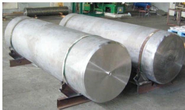
Зливки жароміцного титанового сплаву ВТ3-1 діаметром 840 мм та довжиною 3000 мм
