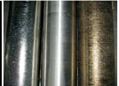
Поверхня зливків титану: оплавлена; механічно оброблена; літа
