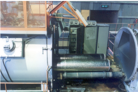
Електронно-променева установка UE185 для оплавлення поверхні зливків
