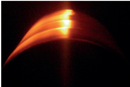
Процес оплавлення зливку титану діаметром 1100 мм
