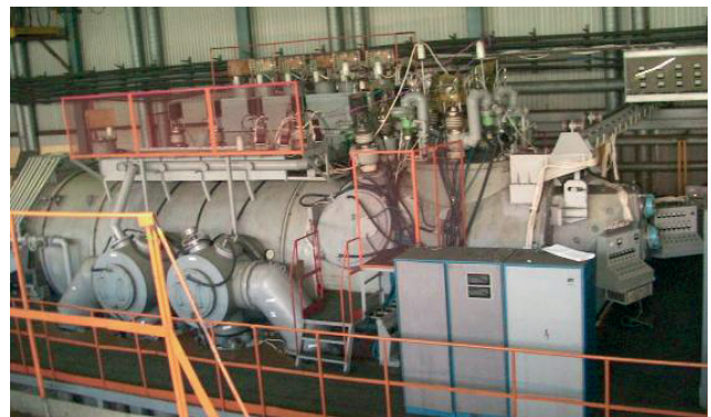
Універсальна електронно-променева установка UE5810
