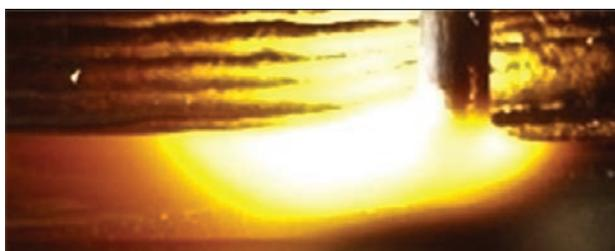
Рис. 2. Розтікання рідкого металу з кінця дроту на підкладці
