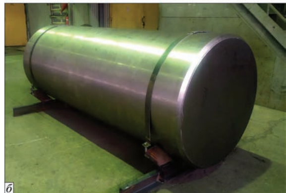
Рис. 4. Зовнішній вигляд зливка титанового сплаву Grade 2 діаметром 1100 мм після ЕППЕ (а) та механічної обробки (б)
