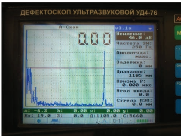
Рис. 5. Типовий УЗК скан середньої частини зливка діаметром 1100 мм
