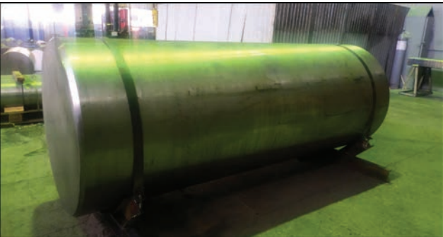
Рис. 4. Зовнішній вигляд зливка титанового сплаву Grade 3 діаметром 1100 мм після механічної обробки
