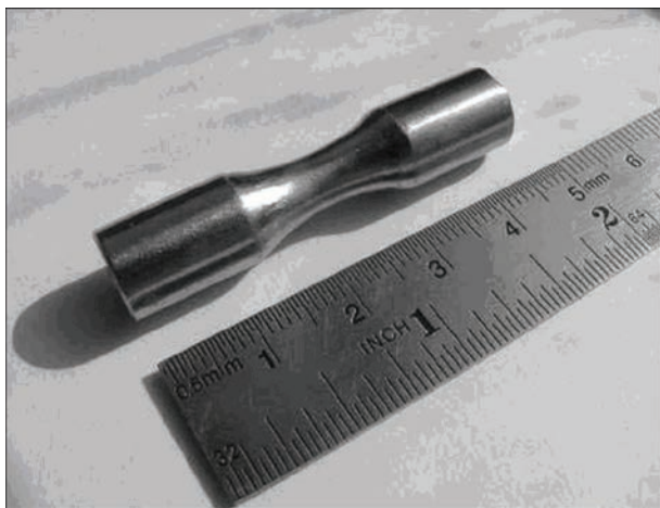
Рис. 4. Зразок для випробувань на розтяг після ІБЗП [14]
