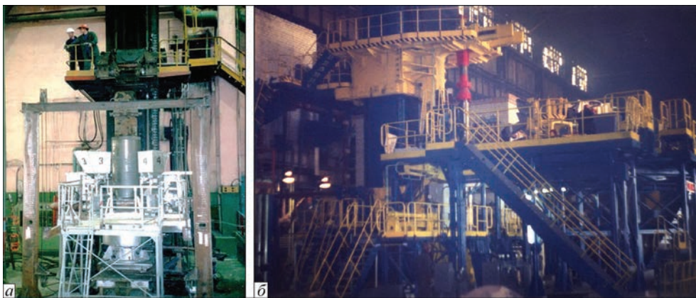
Установки на базі електрошлакових печей ЕШП 10ВГ НЛМК (а) та ЕШП 20 ЗАТ «НКМЗ» (б) для наплавлення прокатних валків стану 2000
