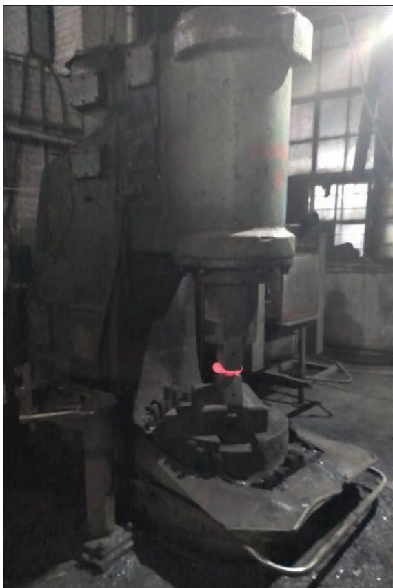
Рис. 3. Процес кування цирконієвого сплаву системи Zr–Nb–Ti на молоті
