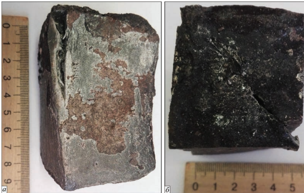
Рис. 4. Вид зливку дослідного сплаву Zr–Nb–Ti, отриманого способом дугового переплаву з невитратним електродом у гарнісажній печі, після деформаційної обробки (кування): а — з боку; б — з торця
