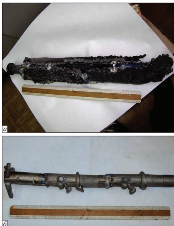
Рис. 2. Витратні заготовки для перепау: а — конгломерати титанових возгонів; б — ливникові системи
