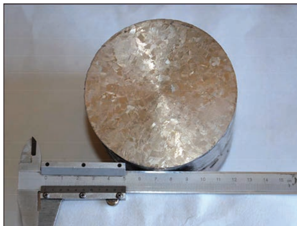
Рис. 7. Структура отриманого зливка титану
