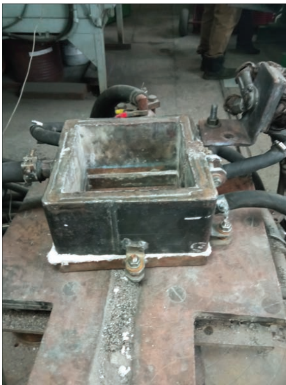
Рис. 1. Струмопідвідний кристалізатор з розмірами формуючої секції 200×200 мм
