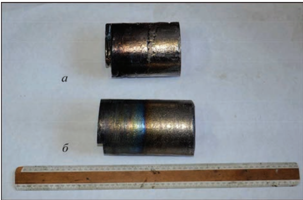
Рис. 3. Зовнішній вигляд поверхні злиwkів: а — переплавлений конгломерат титанових возгонів; б — переплавлені ливникові системи типу BT5-Л
