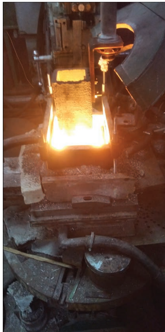
Рис. 2. Процес ЕШН електродом з високохромистого чавуну в ТПК перерізом 200×200 мм
