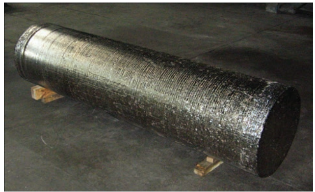
Рис. 1. Зливки сплаву ВТ9, отриманий способом ЕПП
