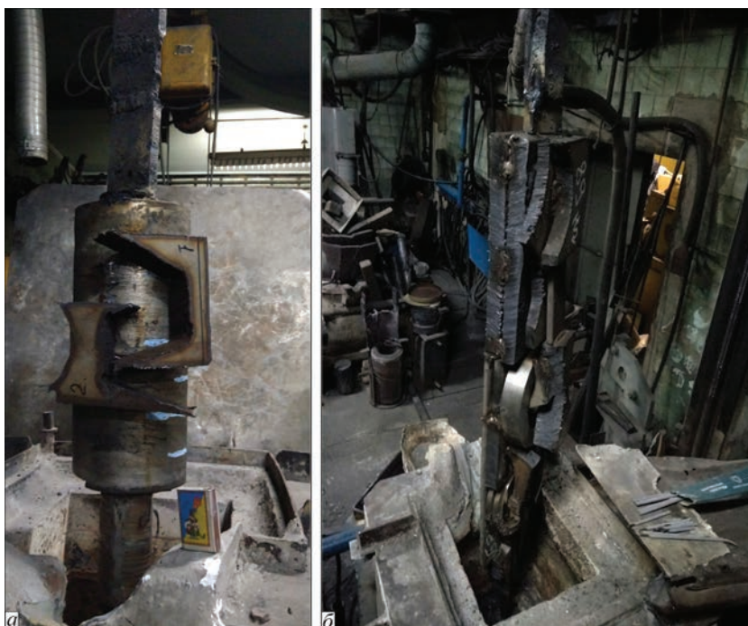
Рис. 2. Зовнішній вигляд електродів із кускового брухту для ЕШТП
