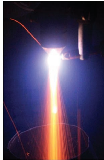
Рис. 2. Схема процесу плазмово-дугового розпилення і сферодизації струмопровідного дроту (а) та зовнішній вигляд процесу розпилення (б): 1 — робоча камера плазмотрона; 2 — вольфрамовий електрод (катод); 3 — канал подачі супутнього газу; 4 — плазмоутворююче сопло; 5 — струмінь розпилюваних частинок; 6 — джерело живлення; 7 — канал подачі плазмоутворюючого газу; 8 — струмообмежувальний опір; 9 — дріт-анод; 10 — механізм подавання; 11 — котушка з дротом; 12 — холодильник з водою [14]
