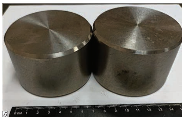
Рис. 2. Зливка діаметром 85 мм зі знятим токарною обробкою альфірованим шаром (а) і виготовлені з цього зливка зразки для кування (б)
