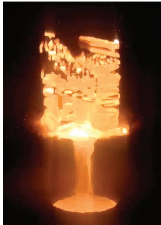
Рис. 3. Процес електронно-променевого переплаву нікелю
