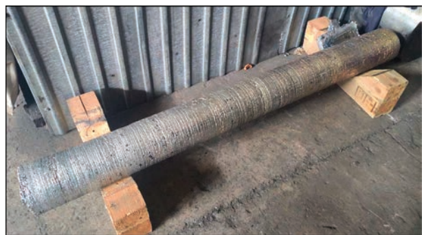
Рис. 4. Зливок діаметром 150 мм з нікелю електронно-променевого переплаву
