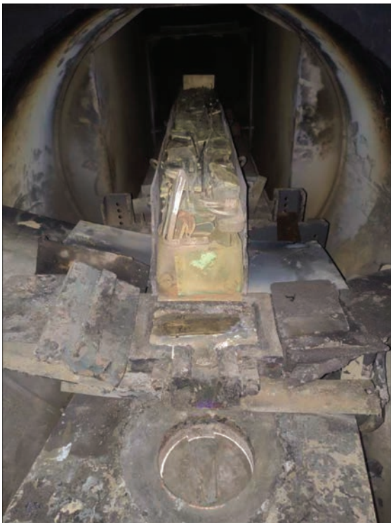
Рис. 2. Шихтова заготовка з низькосортного брухту нікелю
