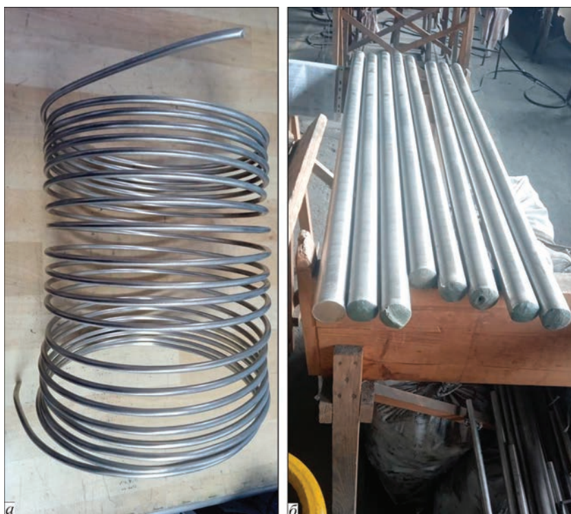
Рис. 5. Напівфабрикати з нікелю марки НП2, одержаного способом ЕПП: а — проволока діаметром 3 мм; б — тягнуті м'які прутки діаметром 40 мм
