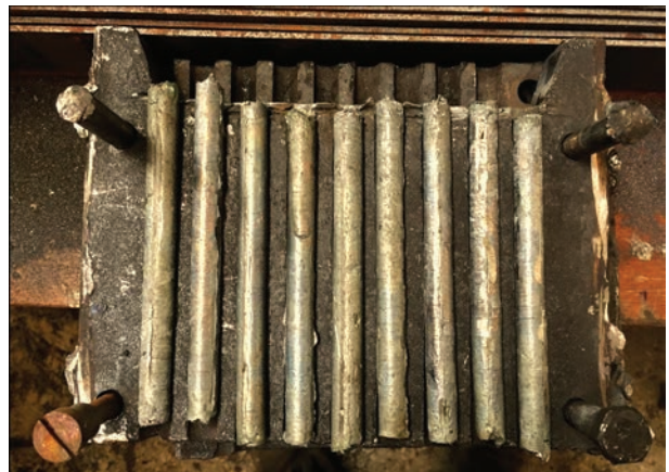
Рис. 5. Зовнішній вигляд виливниці з відлитими прутками
