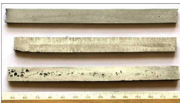
Рис. 6. Макроструктура повздовжнього перерізу прутків з різним вмістом азоту, %: 1 — 0,73; 2 — 0,74; 3 — 0,9
