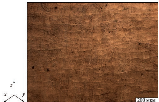
Рис. 3. Мікроструктура сплаву Ti-6Al-4V у площині x - y
