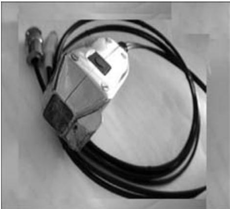
Рис. 4. Внешний вид ЭМАП для возбуждения и приема попечечных волн
