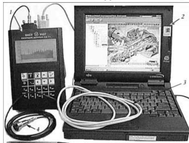
Рис. 4. Простейшая переносная система диагностики врачающегося оборудования производства АО ВАСТ: 1 — сборщик данных — анализатор СД-12; 2 — персональный компьютер типа Notebook; 3 — интерфейсный кабель для обеспечения связи между анализатором и компьютером; 4 — датчик вибрации
