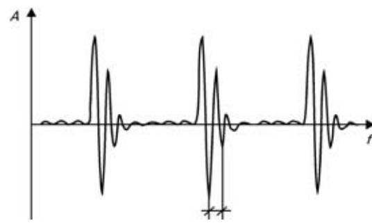
Рис. 5. Осциллограмма подшипника при его диагностировании методом ударных импульсов
