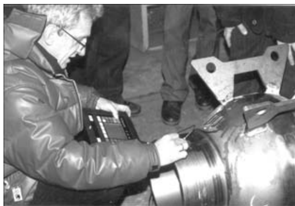
Рис. 6. Представник НВФ «Ультракон» контролює якість зварного шва корпусу засувки для атомної електростанції в умовах ЗАТ «Івано-Франківський арматурний завод» УЗ дефектоскопом FCAWMIKE
