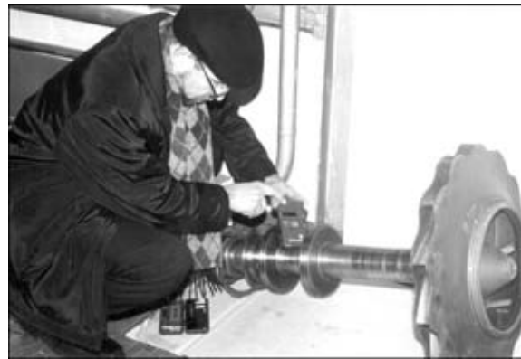
Рис. 5. Визначення твердості напильника валу нагнітача компресорного агрегату в умовах Богородчанської компресорної станції представником фірми «ІНТРОН-СЕТ»
