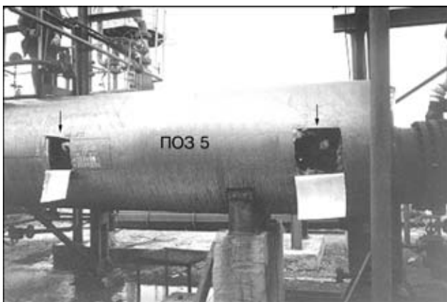
Рис. 1. Теплообменник (места установки АЭ датчиков показаны стрелками)
