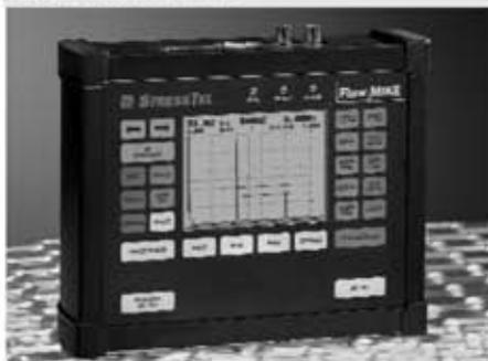
У FlawMike большой высококонтрастный дисплей. Дефектоскоп удобен в использовании благодаря отдельным клавишам для каждой функции. Нажатием на соответствующую клавишу изменяется усиление, включается подсветка, распечатывается протокол контроля, выводятся на экран все текущие установки прибора.
