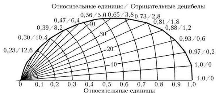
Рис. 1. Диаграмма направленности излучения–приема рэлеевских волн в плоскости поверхности ввода (материал ОК — сталь, ширина источника 14 мм, частота 0,1 МГц)
