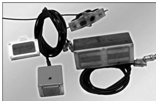
Рис. 8. Некоторые типы ЭМАП, спроектированных в НПП «ВИГОР» и работающих в созданных им установках НК
