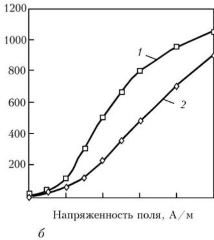
Рис. 7. Основные кривые намагничивания стали Ст.3 в сильных (а) и средних (б) полях: 1 — при k_{\sigma} = 1 ; 2 — при k_{\sigma} = 0,5
