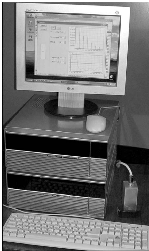
Рис. 3. Двухканальный ЭМА дефектоскоп для ручного и механизированного УЗ контроля сдвиговыми и поверхностными волнами
