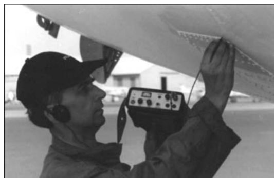
Рис. 4. Контроль обшивки фюзеляжа в зоне откидной рамы самолета АН-12 с помощью дефектоскопа ЛЕОТЕСТ ВД.3.01
