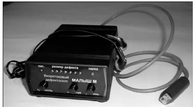
Рис. 7. Вихретоковый дефектоскоп для обнаружения дефектов без специальной подготовки поверхности изделия
