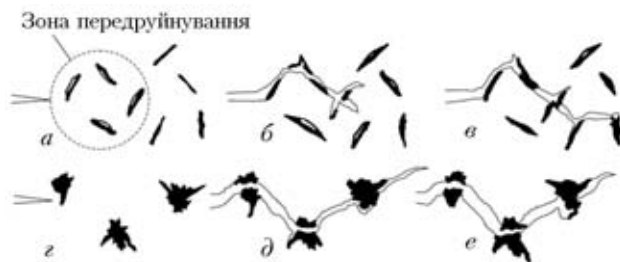
Рис. 1. Схеми процесів, що проходять під час росту тріщини в сірому (а–е) та ковкому (з–е) чавунах: а, з — формування зони передруйнування; б — розгалуження тріщини; в — закриття тріщини внаслідок попадання графітового включення між береги тріщини; д — ріст тріщини по міжфазних границях і через графітові включення; е — закриття тріщини внаслідок високої рельєфності злому [40]
