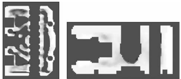
Рис. 5. Сечения трехмерного изображения масляного распределителя координатными плоскостями XOY и XOZ
